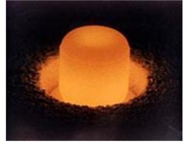
Plutonium oxide pellet.
